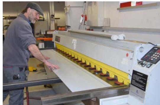
Zweite Schlagschere für Blechzuschnitte bis 2500mm Länge, für Aluminium bis 4mm und Edelstahl bis 2mm
