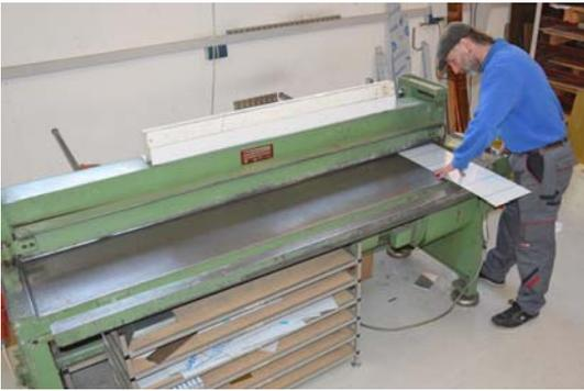
Schlagschere, Blechzuschnitte bis 2m Länge, bis 2mm Edelstahlblech, bis 4mm Aluminiumblech
