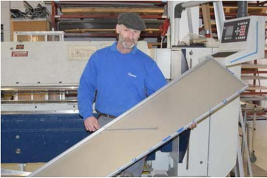
Kantarbeit mit Ausklinkungen an der NC-gesteuerte Schwenkbiegemaschine
